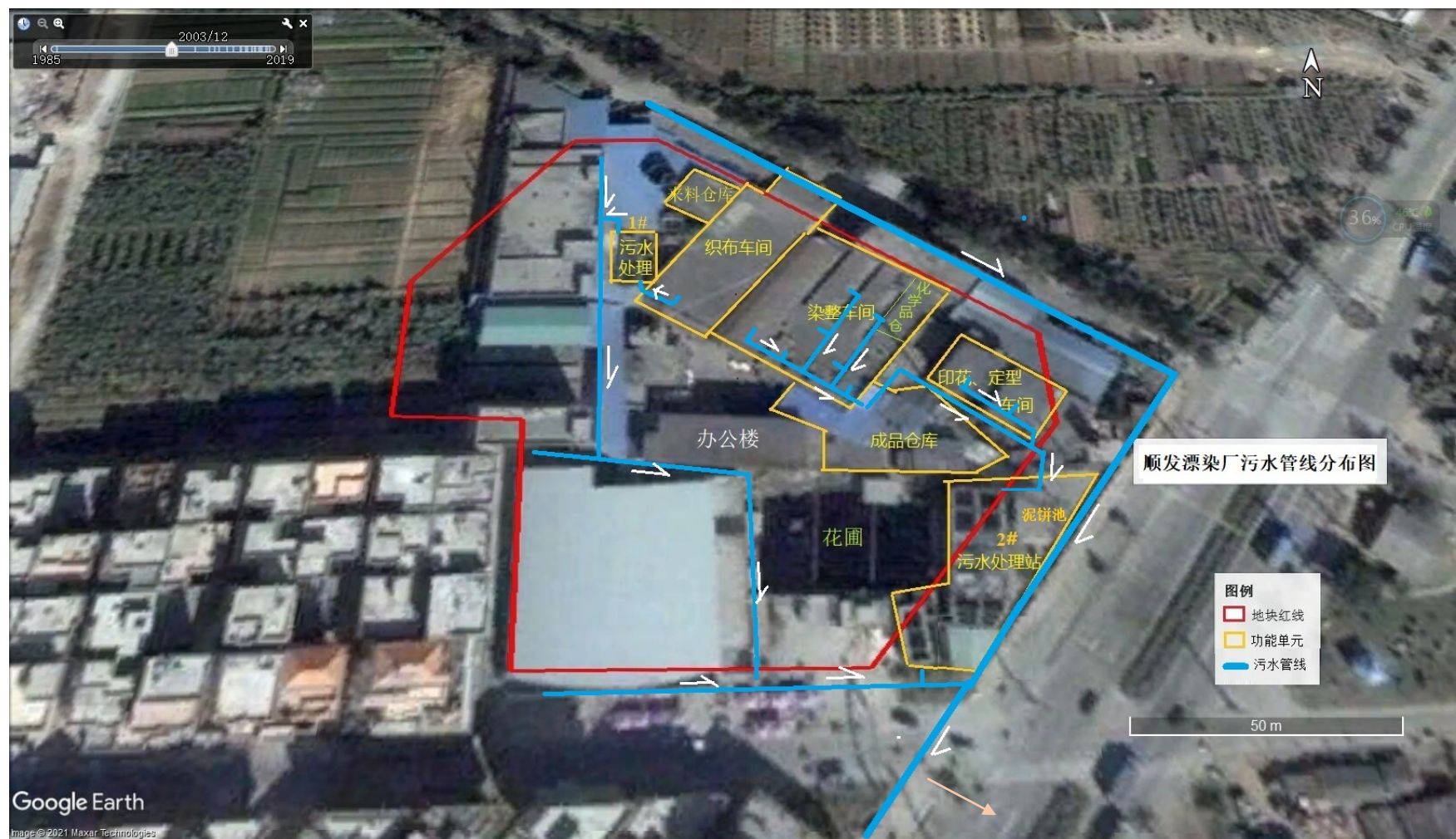
图 3.5-1 目标地块场地地下排污管线布设图
